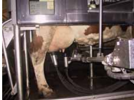
Bild: Zitzenfindung erfolgt mittels Laser (und Kamera)
