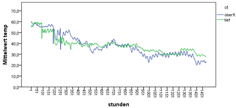
Abbildung 2b: Miete 2, Temperaturverlauf von OS und TS im Sommerkompost
